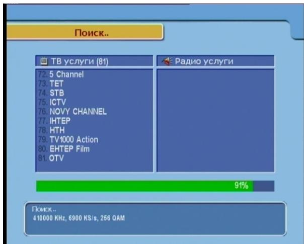
У цієму вікні можна бачити процес налаштування телевізійних та радіо каналів.
